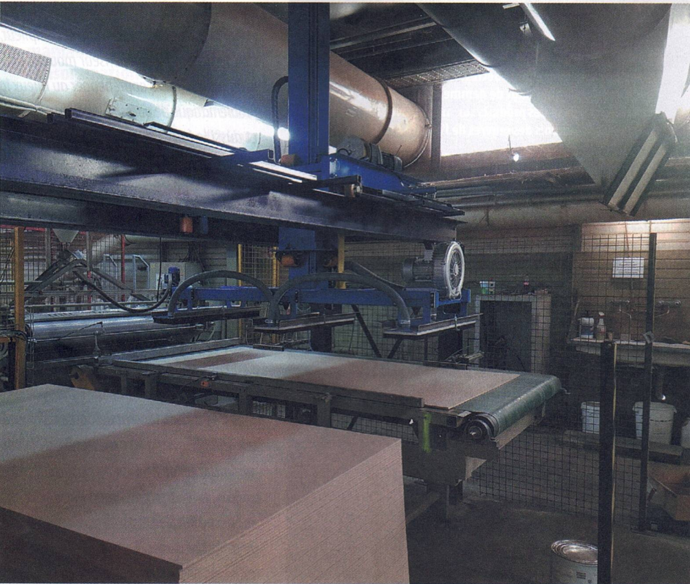
Dépilleur de panneaux MDF, alimentation d'une ligne de collage des parements, capacité 3 cycles par minute, capacité de levage 50 kg, modèle ED 50. (crédit photo : Mousse Process)
